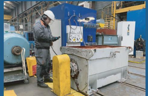
Moteur asynchrone 560kW – 5500V
