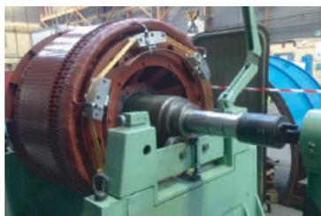
Equilibrage d'un rotor d'excitatrice à diodes tournantes
