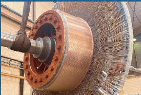
Fabrication d'un induit neuf de génératrice de 1250 kW. Fabrication du collecteur
