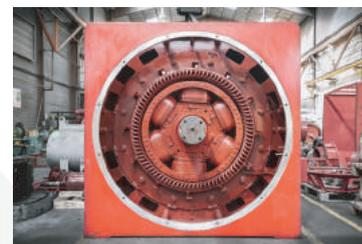
Révision et remplacement d'un arbre de moteur d'extrudeuse – 2500kW
