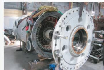
Démontage pour remise en état d'un alternateur d'éolienne de 3500 kVA suite à avarie de roulement
