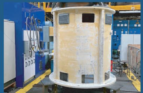
Moteur vertical asynchrone 560 kW – 5500 V
