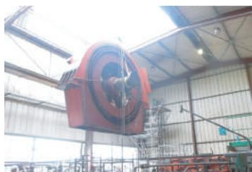
Dépose d'un moteur 7,8 MW - 187,5 tr/mn pour rebobinage de la roue polaire en atelier
