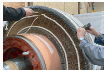
Mise en place du bobinage sur un collecteur
