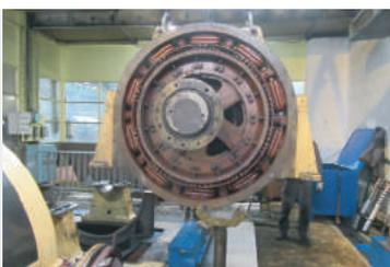
Dépose d'une génératrice à courant continu de 1250 kVA
