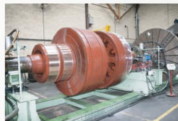
Dépose d'un collecteur d'un double induit de génératrice de 2 x 3000 kW
