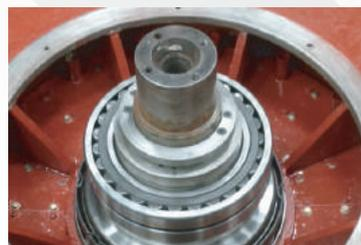
Révision d'un moteur asynchrone de 2 MW – 600 tr/mn
