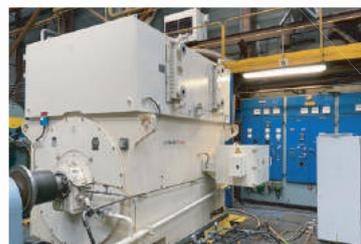
Essais à vide d'un moteur asynchrone 9 MW – 1500 tr/mn
