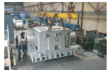
Moteur synchrone à bagues 24 000 kW - 5500V
