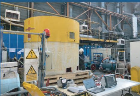
Moteur pompe vertical Asynchrone 2060 kW – 5500V
