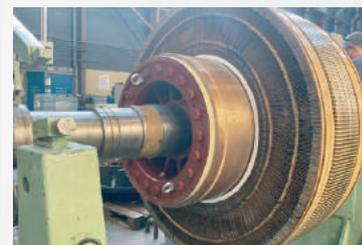
Equilibrage dynamique d'un enduit d'un moteur courant continu de 1450 kW
