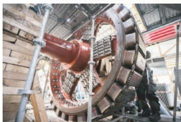
Fabrication des pôles et rebobinage de la roue polaire d'un moteur synchrone de 7,8 MW – 187 tr/mn
