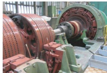
Démontage pour extraction d'une génératrice 2 X 3000kW
