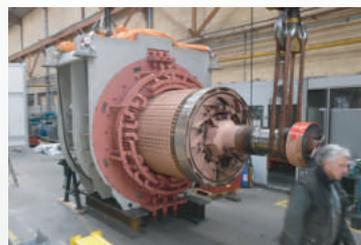
Révision d'un moteur synchrone de 16 MW – 1000 tr/mn
