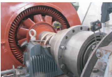
Maintenance d'un moteur synchrone et contrôle de l'alignement
