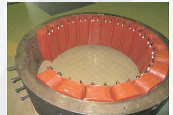
Montage de l'excitateur (rotor + stator) et réalisation des connexions vers les traversées d'arbre
