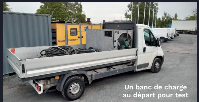
Un banc de charge au départ pour test
